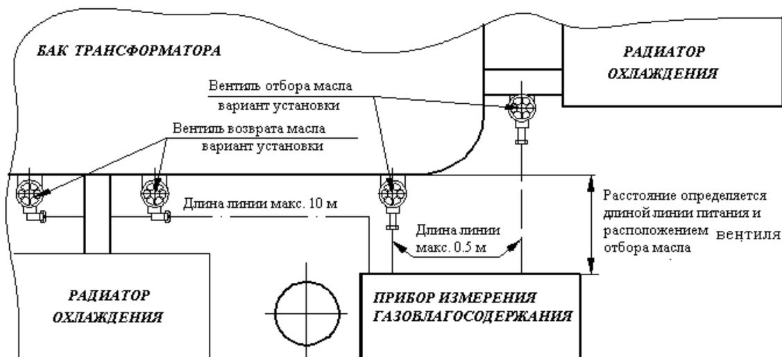
Рис.ПЗ.2.б Установка выносных приборов (вид сверху)
