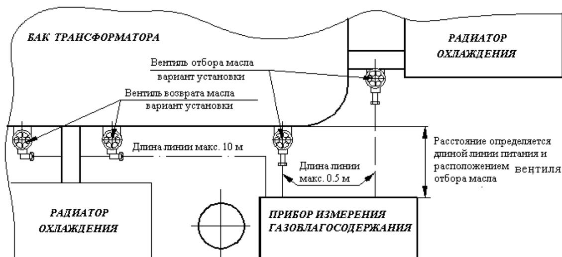
Рис.ПЗ.2.б Установка выносных приборов (вид сверху)
